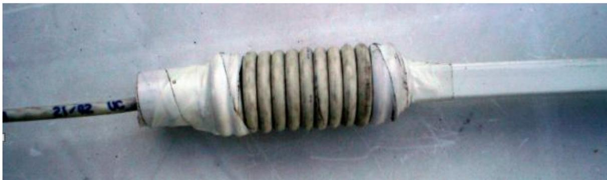
Anche qui, (anche se non si vedono) stessa asola per sorreggere il cavo e ne permettesse l'uscita al centro del tubo/canalina. Abbondante nastratura con nastro isolante e l'antenna era ormai pronta.
