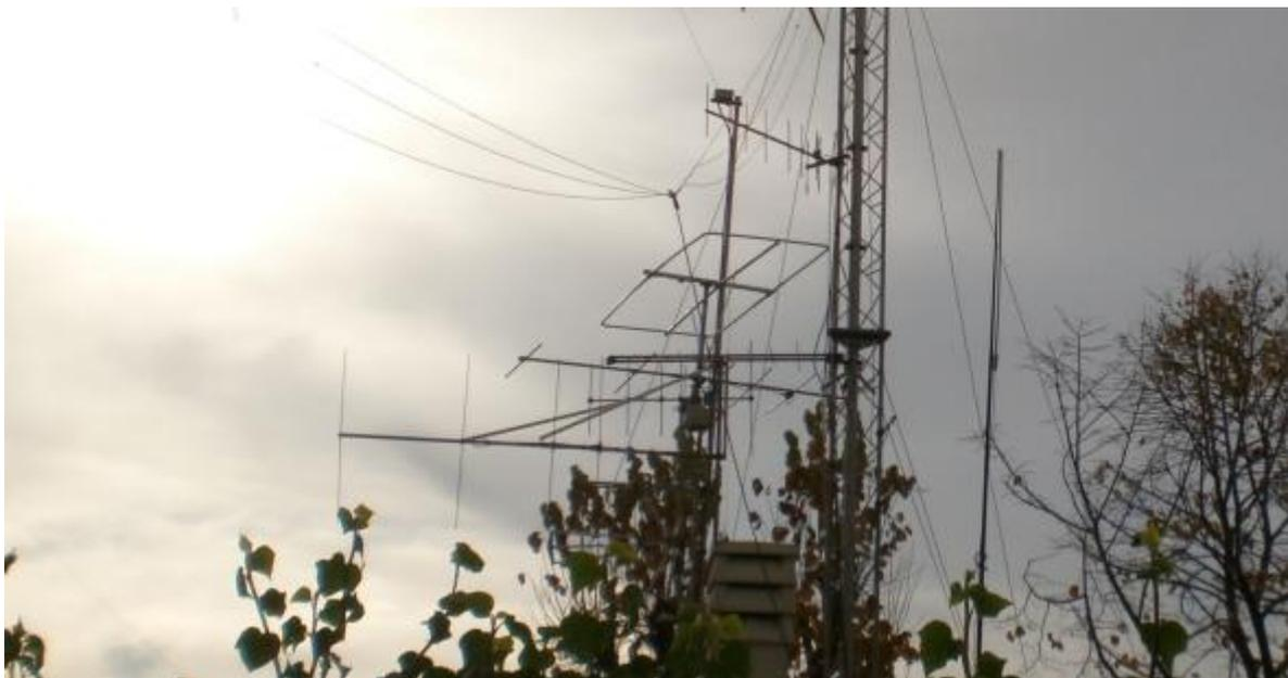
In questo groviglio di antenne si vede la CDP con il dipolo in esame alla destra e la cinque elementi Yagi in polarizzazione verticale quasi in primo piano: entrambe sono alla stessa altezza dal suolo, cinque metri.
