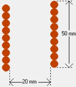
NELLA FORMULA DI MEDHURST UTILIZZATA LA SELF - CAPACITANCE DIPENDE SOLO DALLA RELAZIONE LUNGHEZZA - DIAMETRO DELLA BOBINA. L'ASSEGNAZIONE DEL NUMERO DELLE SPIRE NECESSITA ESCLUSIVAMENTE PER IL CALCOLO DELL'INDUTTANZA E NON INFLUISCE SULL'ENTITA' DELLA CAPACITA' PARASSITA
